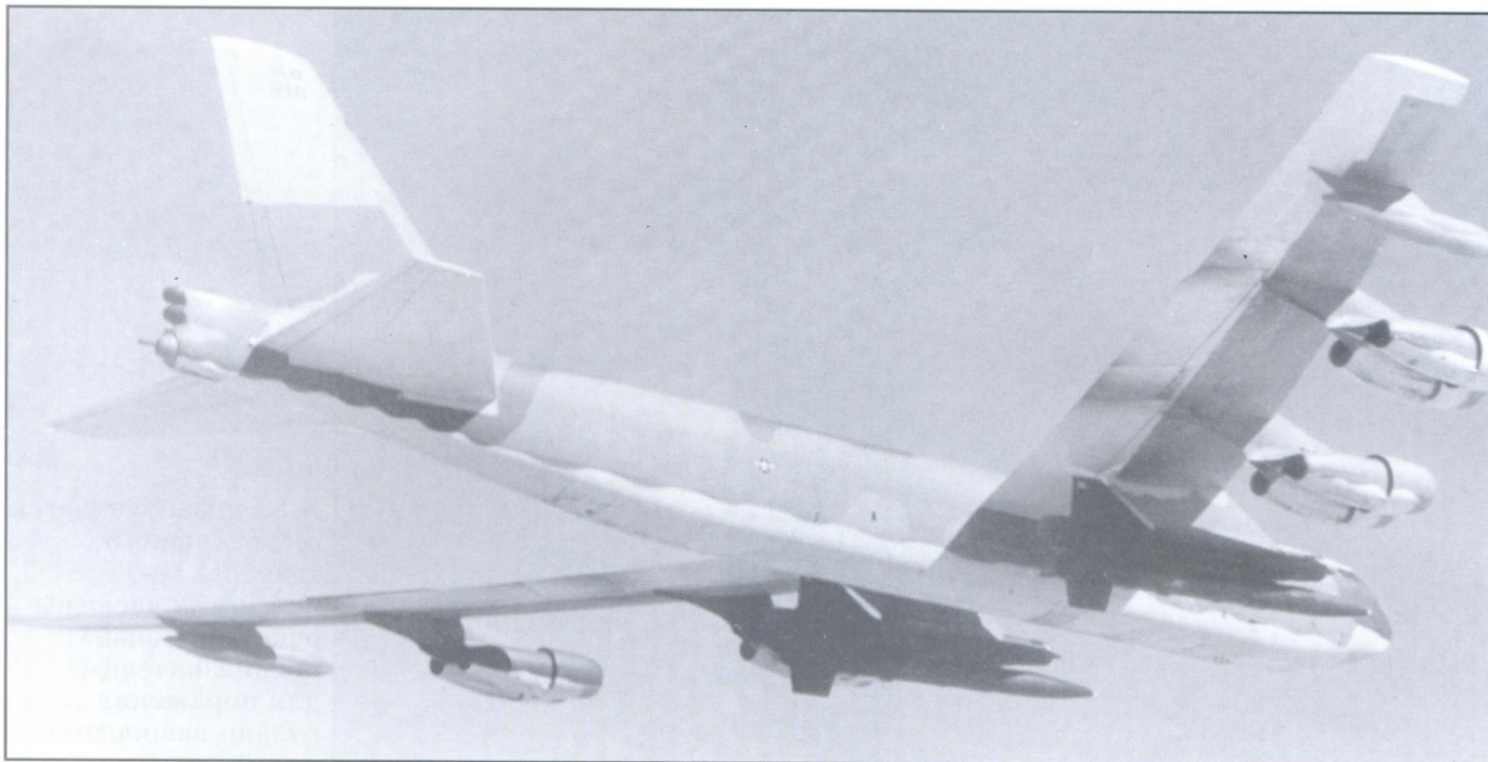
В-52 использовался и в качестве носителя беспилотных сверхзвуковых самолетов-разведчиков D-21
