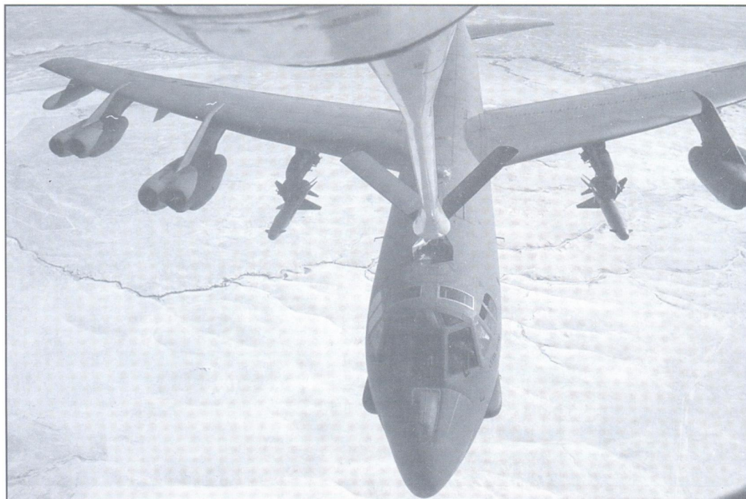
В-52 дозаправляется от воздушного танкера. Под крылом подвешены ракеты «Поппай», предназначенные для поражения сильно защищенных целей
