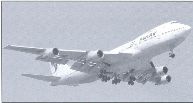
Пассажирский самолет Боинг 747 один из первых полностью использовал преимущества двухконтурных турбореактивных двигателей
